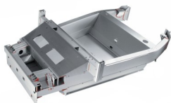
Verlijmde aluminium chassis van de Lotus Elise
