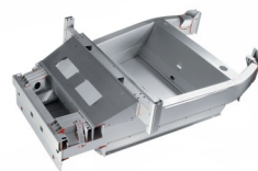
Verlijmde Aluminium chassis van de Lotus Elise
