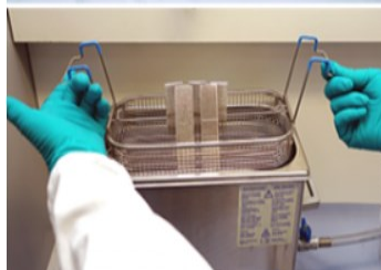
Oppervlaktereiniging in een ultrasoon IPA-bad in de zuurkast
