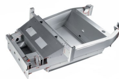
Verlijmde Aluminium chassis van de Lotus Elise
