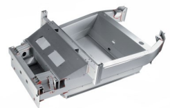
Verlijmd Aluminium chassis van de Lotus Elise
