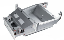
Verlijmd Aluminium chassis van de Lotus Elise
