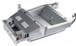
Verlijmde aluminium chassis van de Lotus Elise
