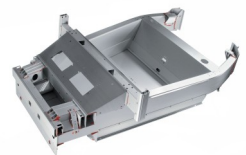
Verlijmde Aluminium chassis van de Lotus Elise
